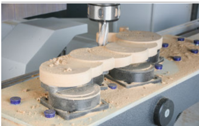
Adapter-Plates ISAP-K1 mit Mono-Bases und Sauger-Cups beim Aufspannen von gekrümmten Holzteilen
