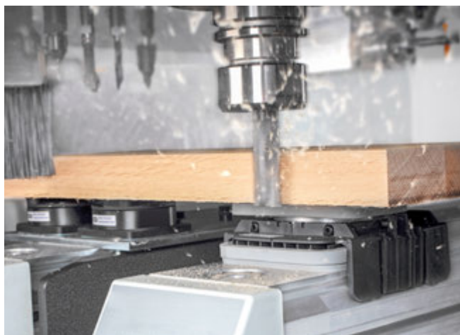
Blocksauger VCBL-K1 im Mischbetrieb mit der Adapter-Plate ISAP-K1 bei der Bearbeitung einer Holzplatte
