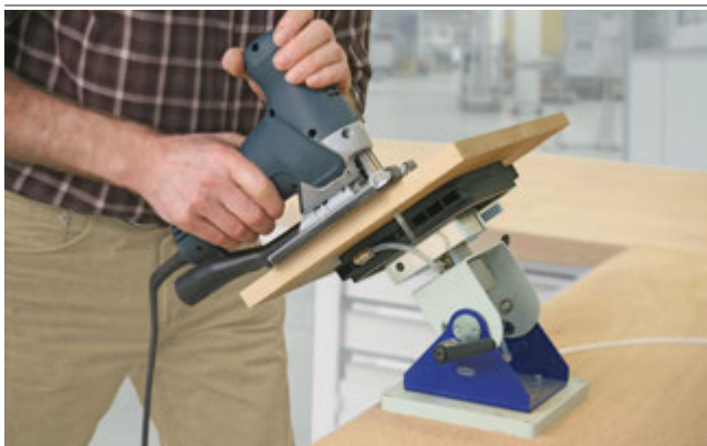
Multi-Clamp VC-M bei der manuellen Bearbeitung eines Holzwerkstücks
