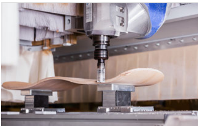
Aluminium-Blocksauger VCBL-A-K2 beim Aufspannen von Massivholz
