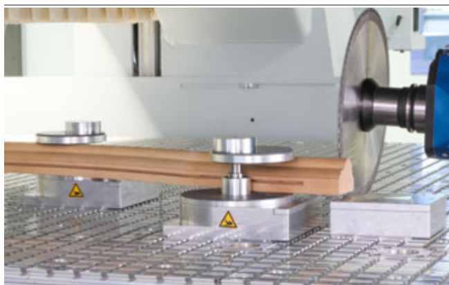
Mechanische Spanner VCMC-R beim Spannen eines gekrümmten Werkstücks
