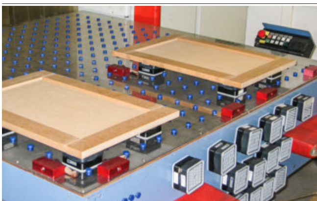
Innospann Steel-Plate mit Mono-Bases und Sauger-Cups
