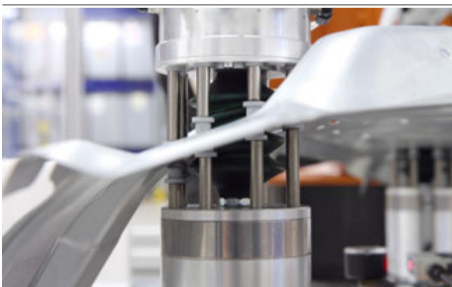
Sauger-Cup SSCB beim automatisierten Greifen und Spannen eines Blechteils
