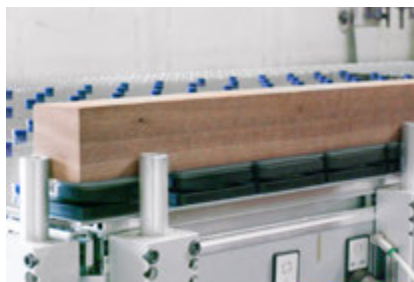
Innospann Steel-Plate montiert auf einem Glatttisch
