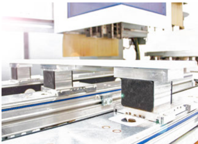
Aluminium-Blocksauger VCBL-A-K2 bei der Bearbeitung von Möbelteilen
