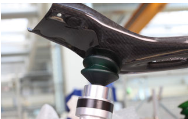
Uni-Base UB und Reference-Cup RSC beim Aufspannen eines CFK-Bauteils
