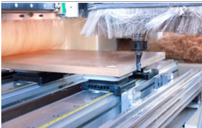
Blocksauger VCBL-S4 beim Einsatz auf SCM-Konsolen
