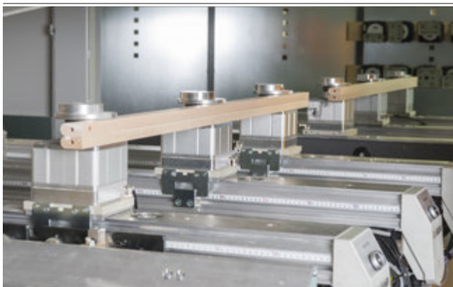
Mechanische Spanner VCMC-K1 beim Aufspannen von Rahmenteilen
