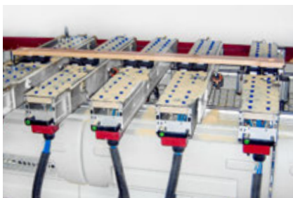
Innospann Steel-Plate montiert auf einem Konsolentisch
