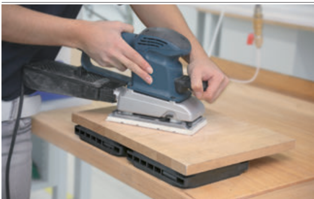
Multi-Clamp Saugplatten VC-M-SP bei der manuellen Bearbeitung eines Holzwerkstücks
