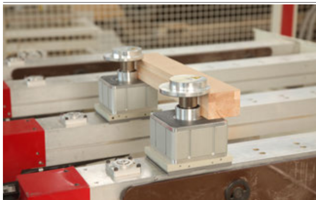
Mechanische Spanner VCMC-K2 beim Aufspannen von Rahmenteilen
