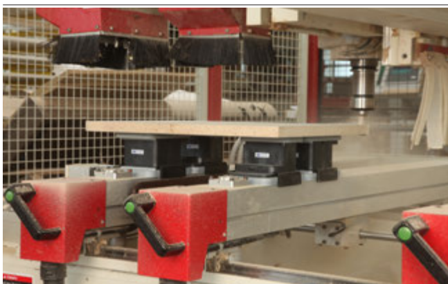
Blocksauger VCBL-K2 beim Aufspannen eines Werkstücks
